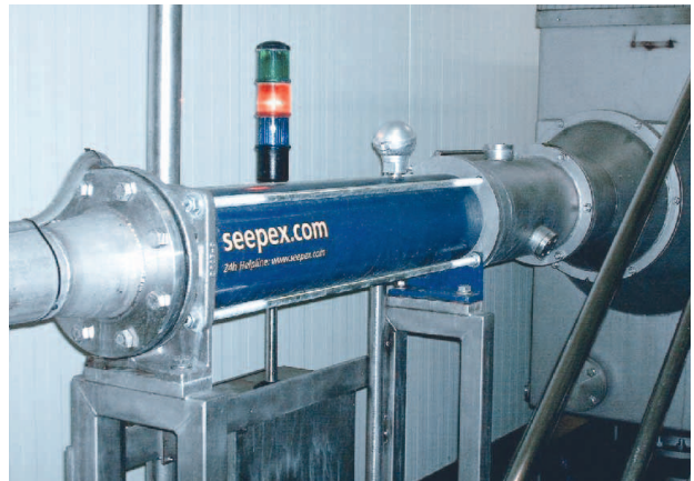
Pumpe der Baureihe BTM mit integriertem Feststoffabscheider und Schneidmessern zur Verarbeitung von Obst- und Gemüseabfällen.
